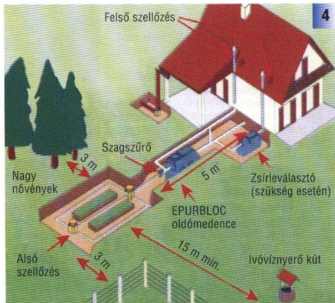
4. ábra. Alapváltozatú technológiai lánc áttekintő képe
